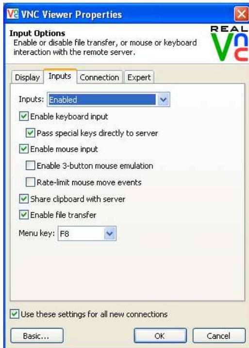
Figure 19. VNC Viewer Options - Inputs tab
